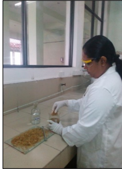
ස්වභාවික රබර් ආශ්‍රිත සංයෝග නිපදවීමට වැටකෙයියා කෙඳි පෘෂ්ඨික පිරියම් කිරීම
