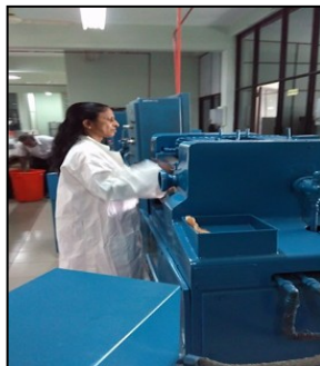
රූප සටහන 3: විශ්ලේෂණයට භාජනය කිරීමට පෙර රබර් නියැදි සමජාතීකරණය කිරීම
