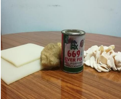
රූපසටහන 2: ස්වාභාවික රබර් සහ නියෝප්‍රීන් රබර් මිශ්‍රිත ගම් වර්ගයක් නිපදවීම
