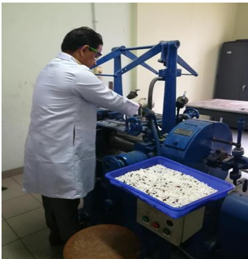
රූපසටහන 4: ඉවතලන දෘඩ පොලිසුරිතේන් ෆෝම් රබර් සඳහා ප්‍රතිවක්‍රියකරණ ක්‍රියාවලියක් අත්හදා බැලීම.
