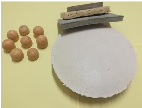
රූපසටහන 3: ක්‍රීම් කරන ලද සාන්ද්‍ර රබර් කිරි සහ ක්‍රේප් රබර් භාවිතයෙන් ෆෝම් රබර් නිපදවීම
